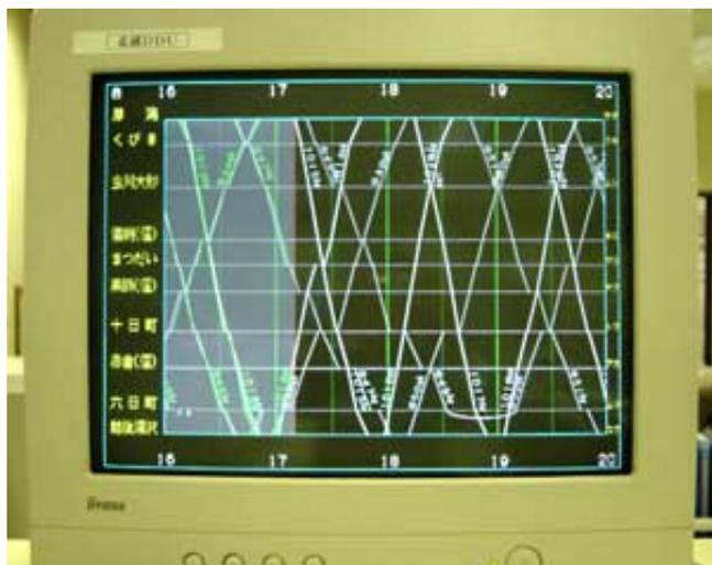
写真4 実績d記録ダイヤ 白線が計画、緑線が実際に走った様子を示す。
