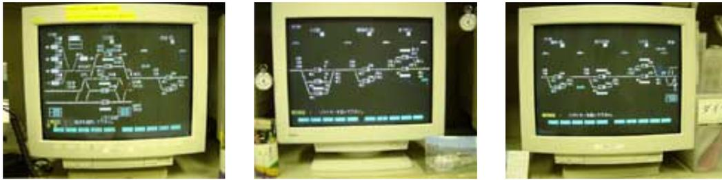
写真2 列車集中制御装置
