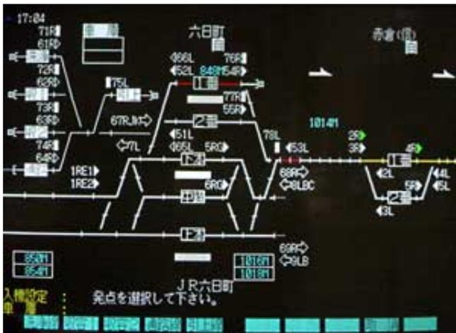
写真3 実際の制御監視装置の画面(六日町駅から赤倉信号場)
