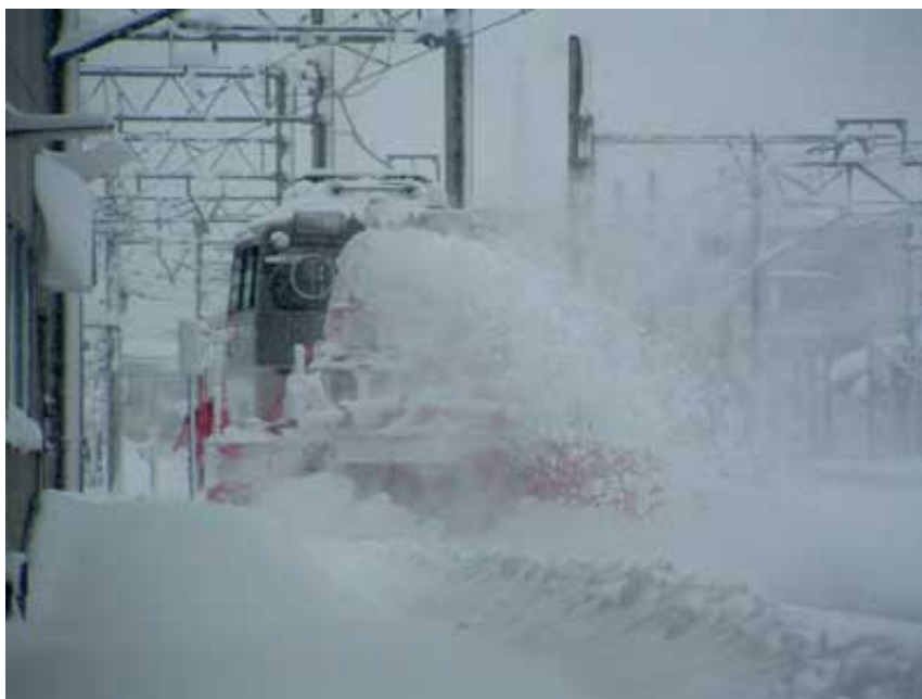
MR600型 自重 23.0トン、雪装備(段切翼なし)31.0トン 雪装備(段切翼あり)32.2トン
