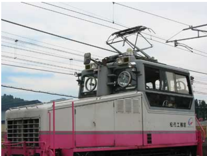
MR600型モーターカーのパンタグラフを上昇した姿 (除雪装置を取り外した夏の状態)
