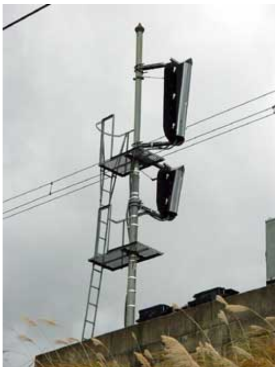
信号機に装着された着雪防止カバー（くびき駅場内信号機）
