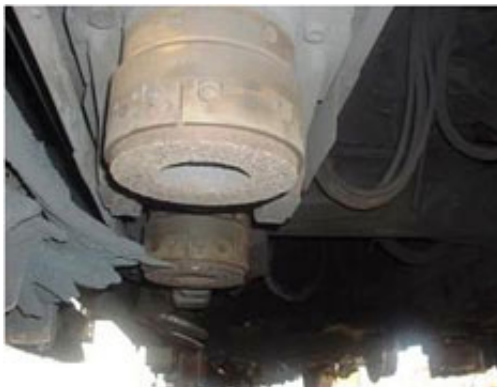
左右に各8個の砥石をもち毎分3,600回転で削正する
