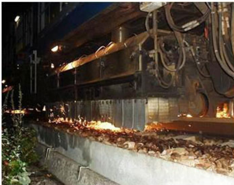
左右に各8個の砥石をもち毎分3,600回転で削正する
