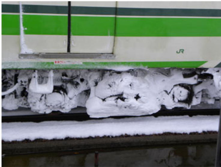
雪中運転により台車部分に抱え込んだ雪 JR線電車の例
