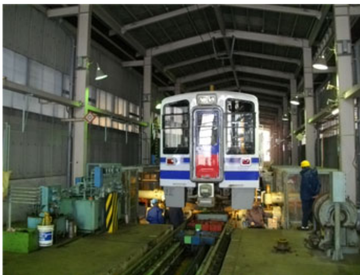
アントと呼ばれる車両移動車で在姿フライス盤上に 乗せられたHK100形電車
