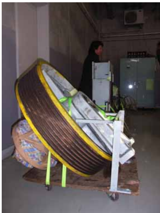
綱車（直径：900mm、溝形状：U溝アンダーカット付）主索径：14mm
